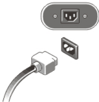
Figure 6. Connexion de l'alimentation
